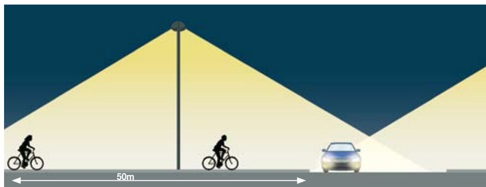
Figura 55.- Enllumenat a les interseccions
